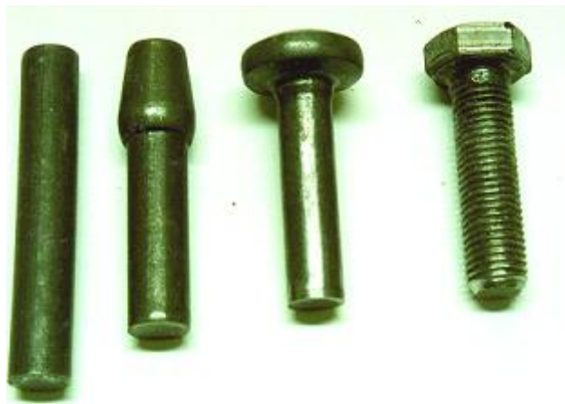
Figura 1. Seqüência de passes de recalque para obtenção de parafuso sextavado de rosca métrica M9. D esquerda para a direita: etapa 1 (tarugo), etapa 2, etapa 3 e etapa 4 (corte).
