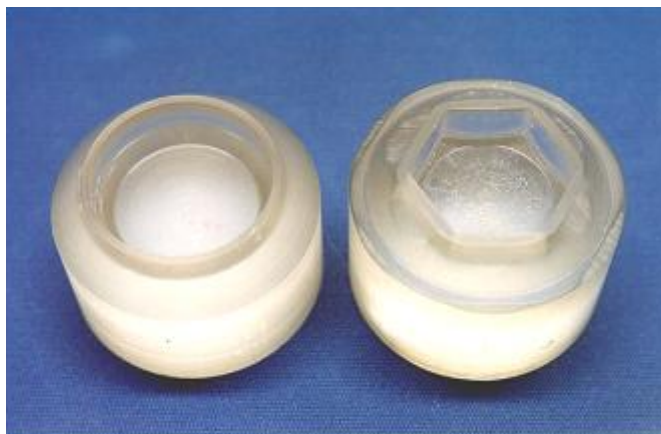
Figura 2. Punções em resina usados para simular a seqüência de passes para obtenção do parafuso sextavado de rosca métrica M9.
