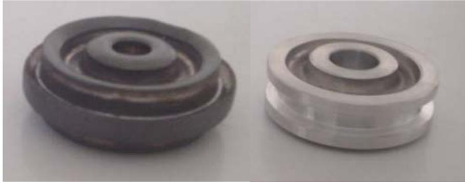
**Figura 10.** Comparação entre a forma final da roda em alumínio a peça forjada final em chumbo.
