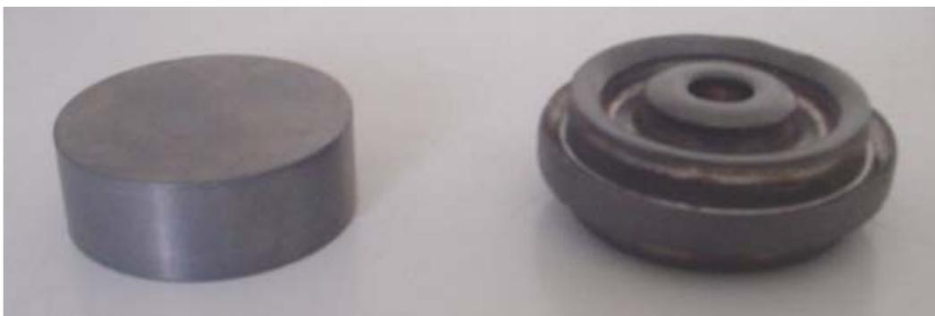
**Figura 9.** Disco usinado e peça forjada final de chumbo.
