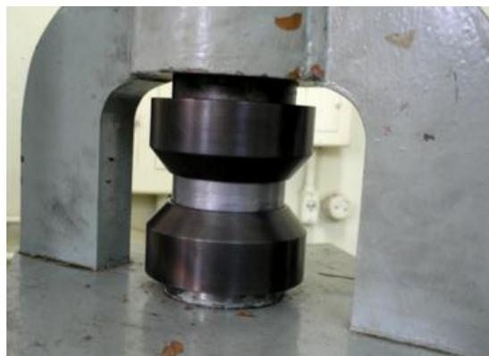
**Figura 6.** Posição inicial do teste: ausência de folgas verticais entre a matriz superior e o disco.
