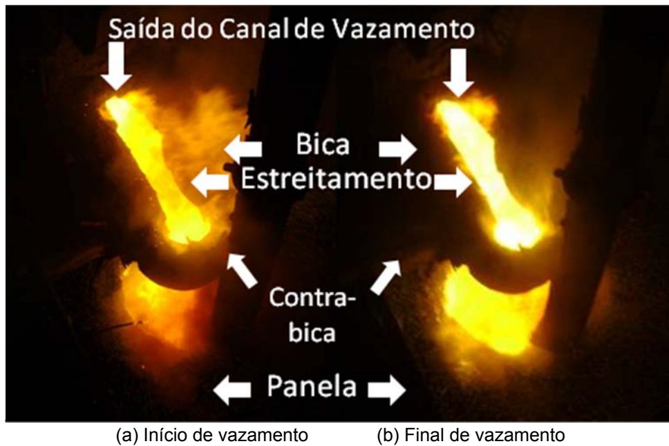
Figura 4 – Imagens da contrabica atual em dois momentos: (a) no início de vazamento, (b) no final do vazamento.
