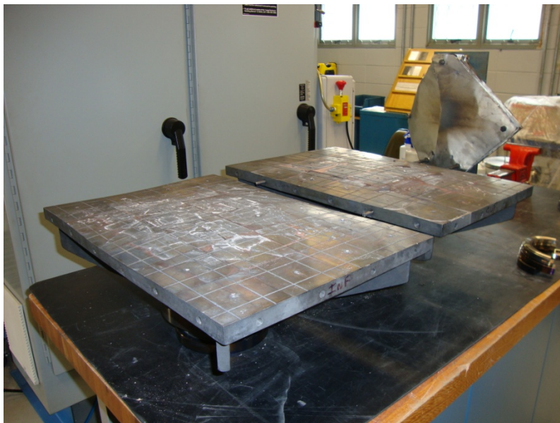
Figura 1. Foto da mesa anterior, retirada do forno de soldagem por difusão.
