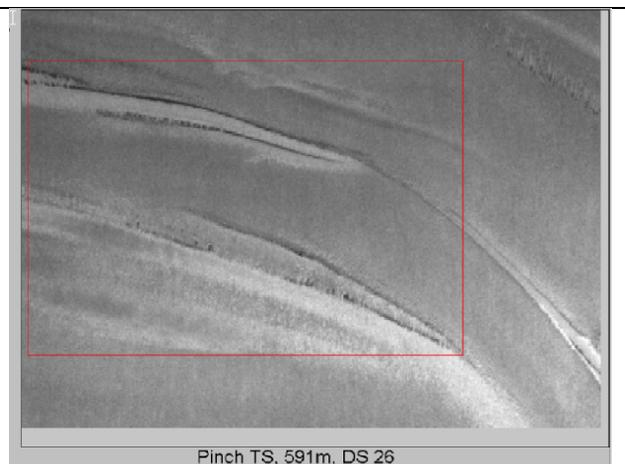
Figura 6 – Repuxado na cauda da tira e no lado de acionamento – Pouco impacto sobre o rendimento do produto mas com desdobramento sério pois pode marcar os cilindros.
