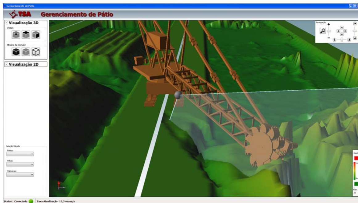
Figura 12. Tela com detalhe da recuperadora RC-04 em operação.
