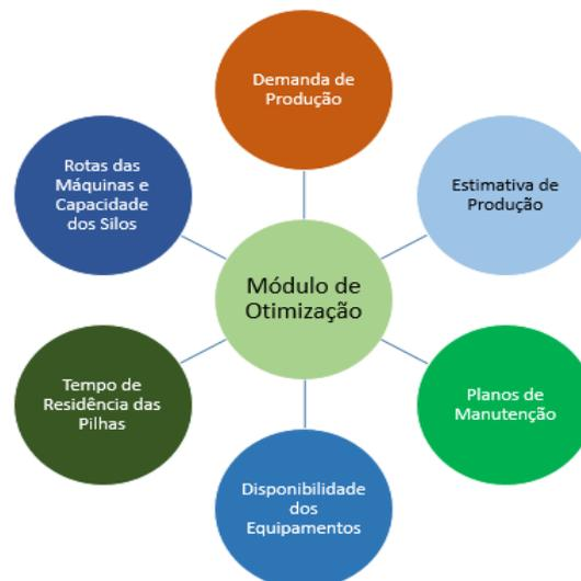
Figura 4 - Diagrama de visão geral do módulo de otimização com dados de entrada para funções de restrição.
