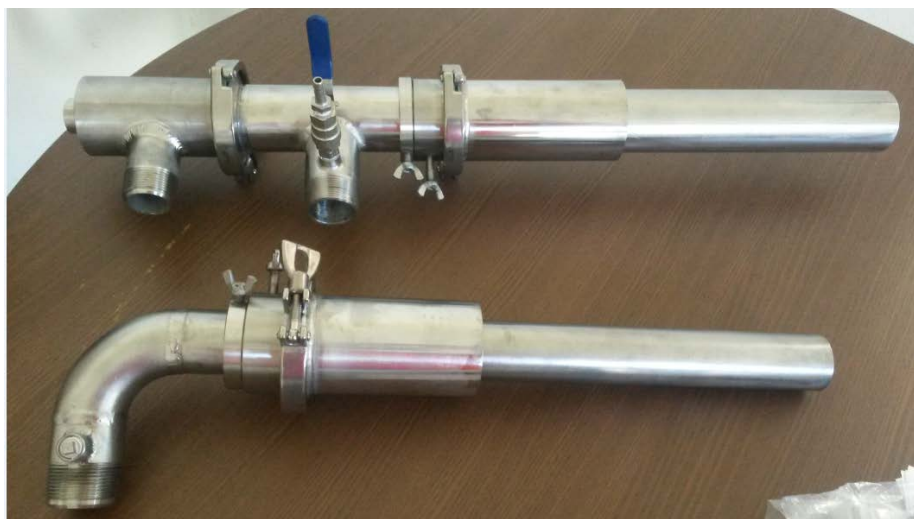
Figura 2.c – Componentes principais do queimador Optifire
