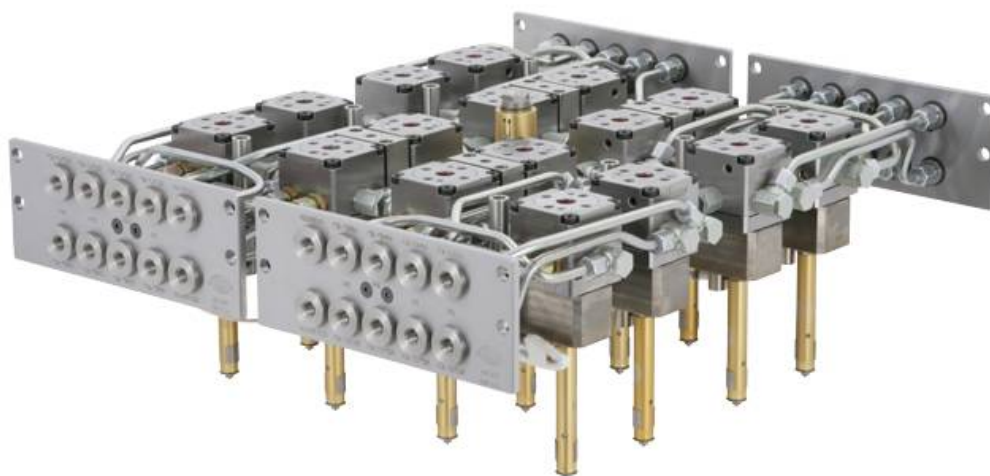
Figura 5. Sistema de câmara quente valvulado hidráulico, unitizado com os bicos rosqueados no manifold e com as instalações de elétrica, hidráulica e refrigeração pré-instalada pelo fabricante do sistema antes de entregar ao cliente.
