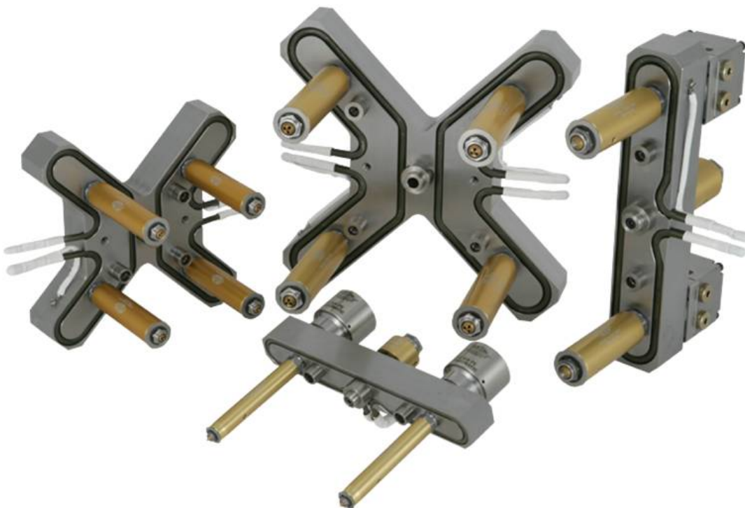
Figura 4. Sistema de câmara quente com bicos rosqueados no manifold eliminam os anéis de vedação entre manifold e bicos e facilitam a montagem do sistema no molde.
