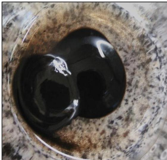
**Figura 6.** Aglomerado de nanopartículas utilizando 3,5M NaOH.
