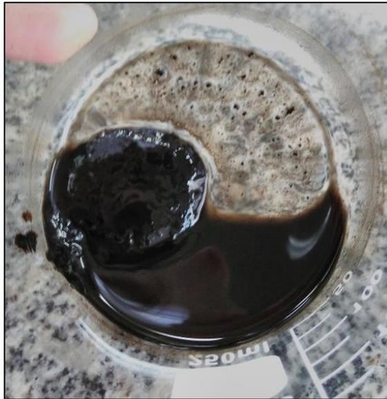
**Figura 7.** Nanopartículas magnéticas após decantação.
