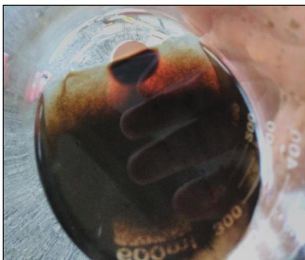
**Figura 5.** Formação de nanopartículas de magnetita pela razão 0,6
