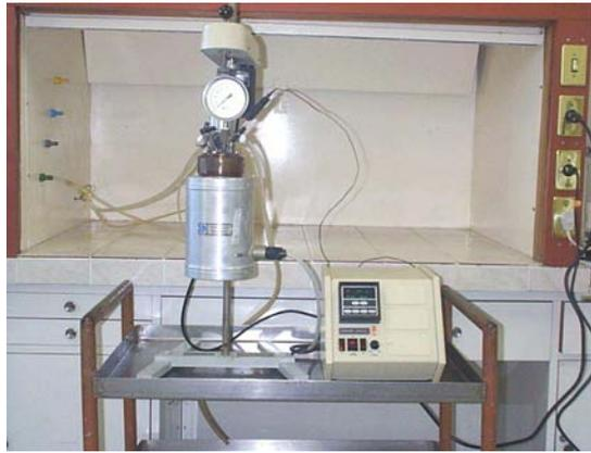
Figura 1. Reator Parr utilizado nos experimentos.
