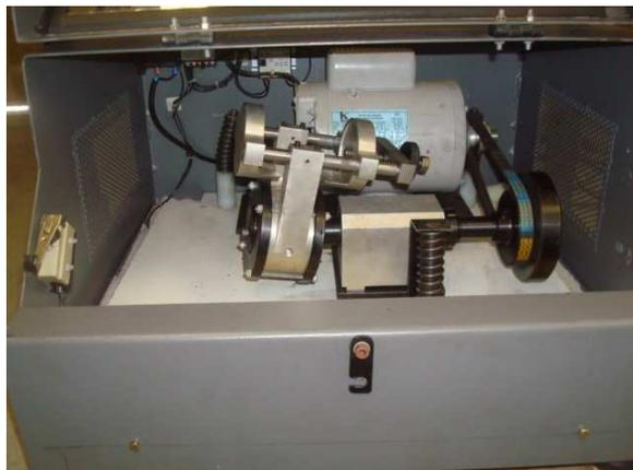
**Figura 3.** Moinho SPEX utilizado no processo de moagem de síntese de NbC.
