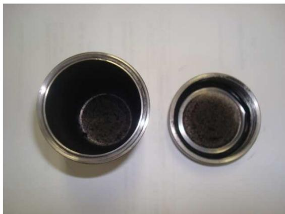
**Figura 4.** Jarra de INOX utilizado no moinho SPEX no processo de moagem de síntese do NbC.
