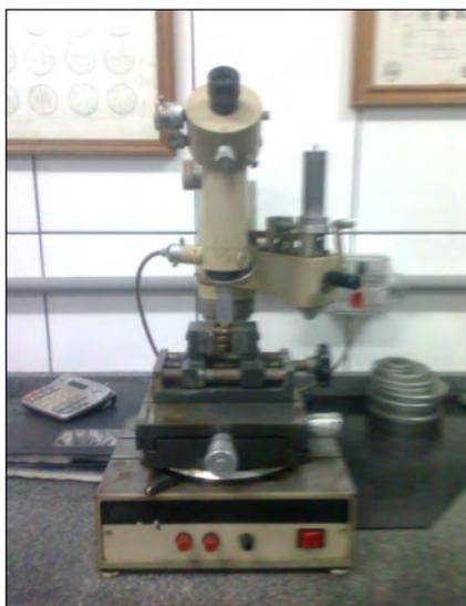
**Figura 8:** Microdurômetro Hardness Tester 3202 (Zwick).
