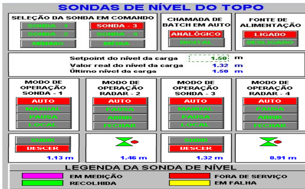
Figura 5 - Tela gráfica de operação das sondas de nível do topo do AF#3 da CSN;
