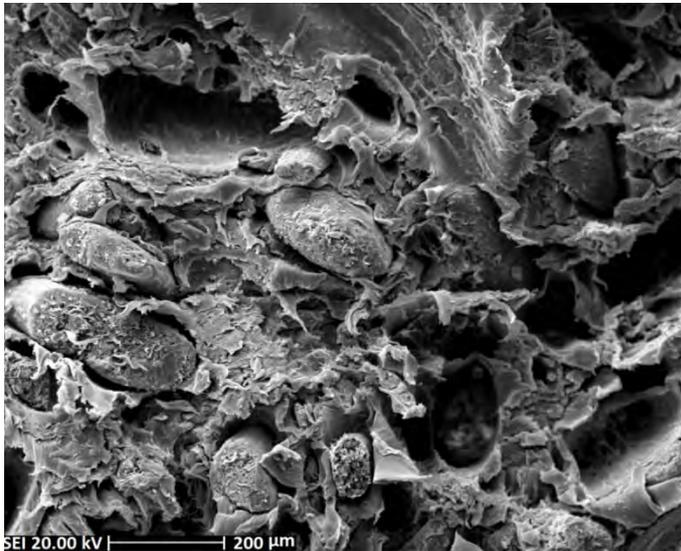
**Figura 9.** Fractografia em MEV: detalhe da região central da superfície fraturada no ensaio realizado a 35 Hz.
