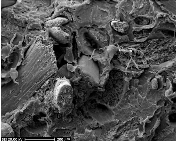
**Figura 6.** Fractografia em MEV: visão detalhada da região central da superfície fraturada no ensaio realizado a 5 Hz.
