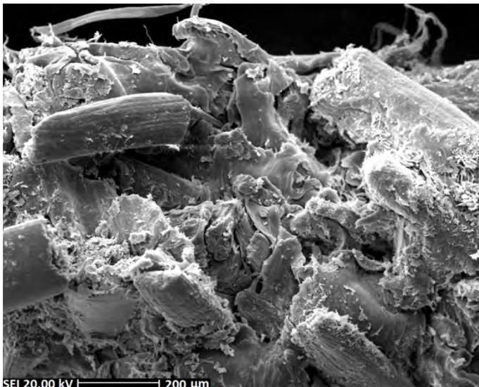
**Figura 10.** Fractografia em MEV: região próxima a superfície do corpo de prova ensaiado a 35 Hz.
