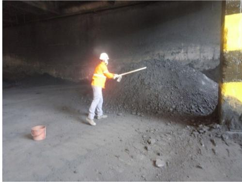
Figura 3: Amostragem de umidade nas tortas dos filtros.
