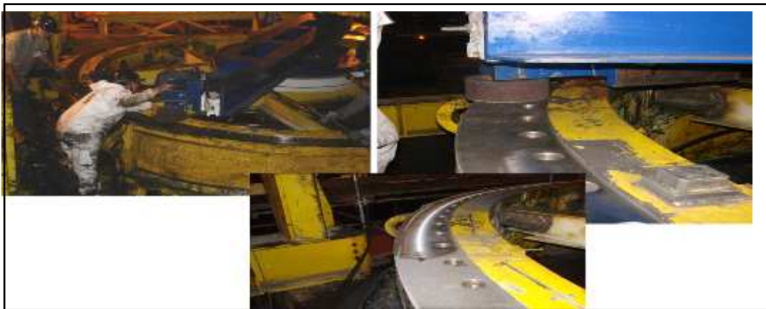
Figura 15 – Usinagem da base de apoio inferior do rolamento de giro.
