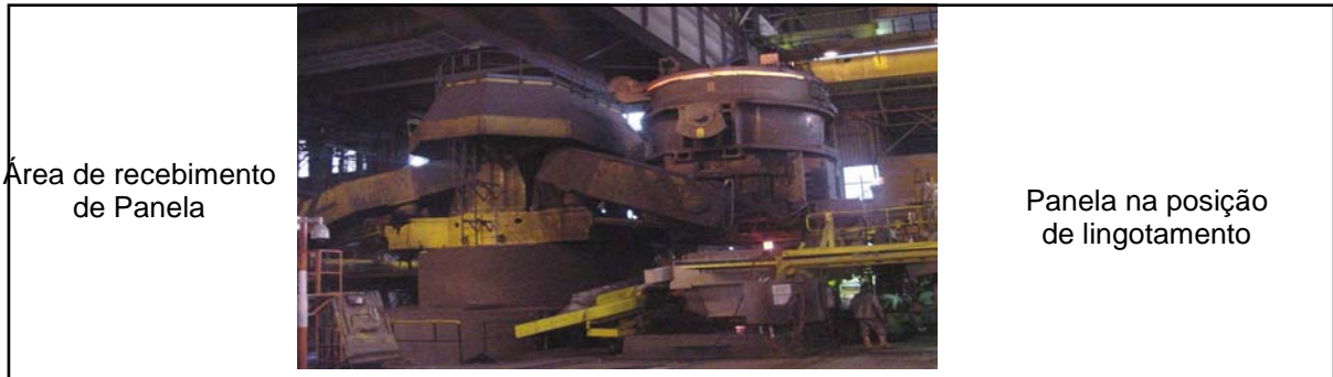
Figura 2 – Detalhamento do funcionamento da torre giratória.
