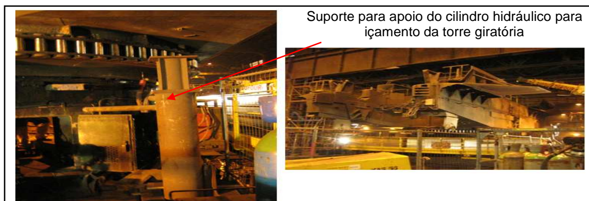
Figura 9 – Metodologia de troca de rolamento através de cilindros hidráulicos.
