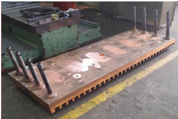
Figura 4. Stave de cobre fundido
