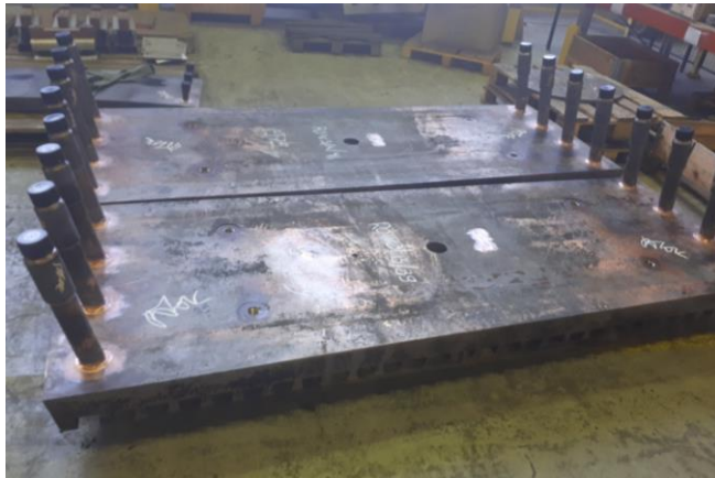
Figura 3. Staves de cobre laminado
