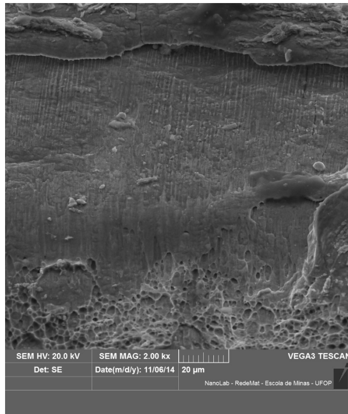
Figura 7 – Fractografia de um corpo de prova submetido ao ensaio de corrosão sob tensão com carga constante; 2000X; MEV.
