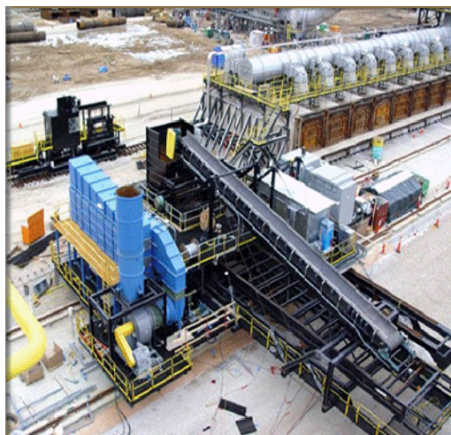
Figura 7. Vista da Máquina que faz o enforcamento do carvão ( Pusher Charger Machine ).
