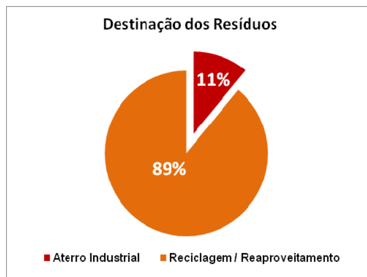
Figura 5. Destinação de resíduo na Coqueria Heat-Recovery da SunCoke Energy.
