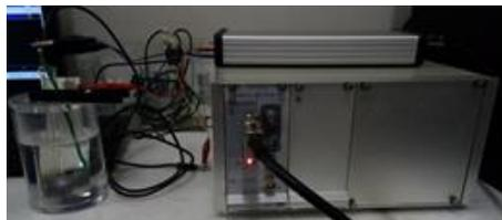
Figura 1. Potenciostato e célula eletroquímica utilizada nos ensaios de polarização potenciodinâmica.
