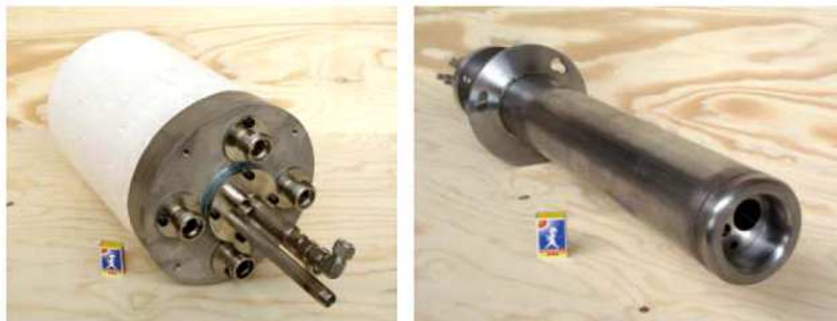
Figura 7- A figura à esquerda mostra um queimador oxi-combustível cerâmico de 2MW – tipo flameless. À direita, um queimador oxi-combustível flameless refrigerado a água. Ambos integram ignição e célula UV.
