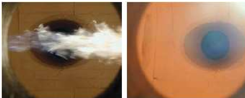
Figura 9 – A imagem da esquerda mostra uma chama oxí-combustível convencional, enquanto a imagem da direita mostra o mesmo queimador com efeito flameless.
