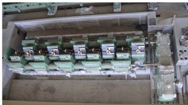
Figura 2. Disposição convencional de bloco de fio-máquina com 10 cadeiras
