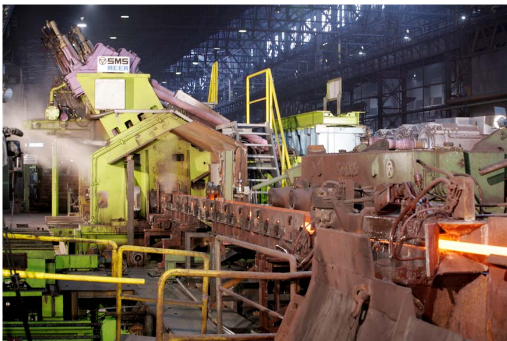
Figura 7. PSM ® - Tecnologia avançada de dimensionamento de 3 cilindros na DEW Siegen/Alemanha.
