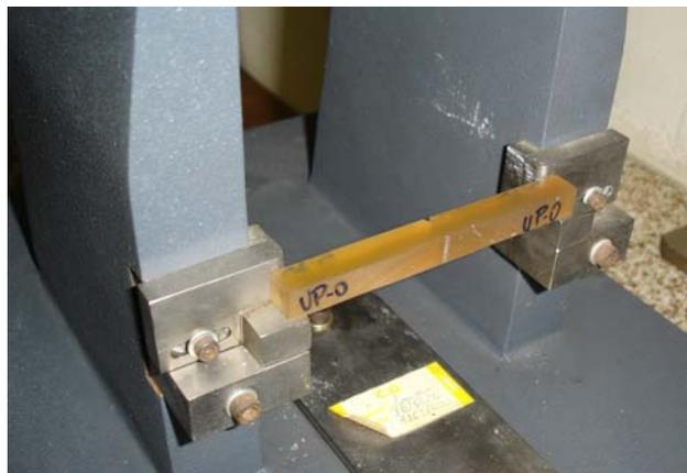
**Figura 2** – Corpo de prova em posição no pêndulo Charpy.
