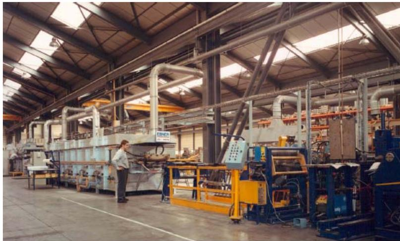
**Figura 3.** Foto da seção de entrada e de forno de austenitização.<sup>(3)</sup>
