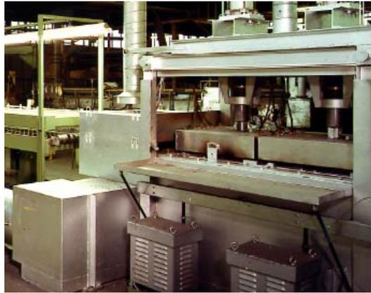
**Figura 7.** Foto forno de placas de endireitamento.<sup>(3)</sup>
