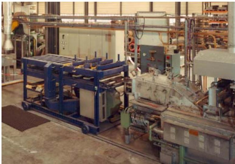
**Figura 6.** Foto das seções de resfriamento metálico e resfriamento com jatos de ar.<sup>(3)</sup>
