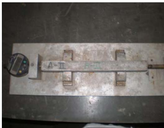
**Figura 2.** Medição da expansibilidade da barra.
