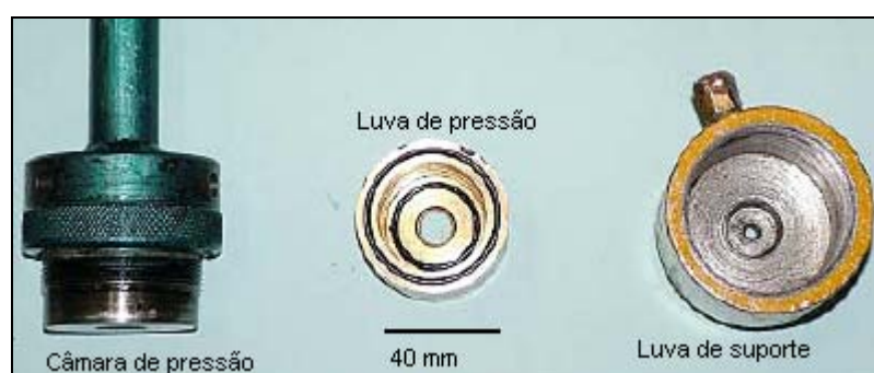
Figura 2. Detalhes da câmara de pressão, luva de pressão e luva de suporte. Pedido de patente em análise.
