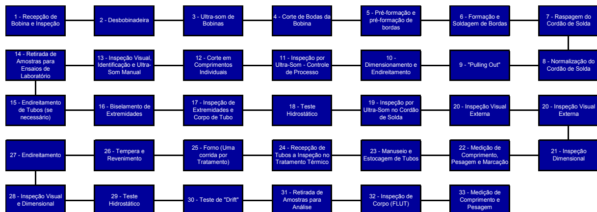
Figura 1. Fluxograma de fabricação de soldados por resistência elétrica e tratados térmicamente na planta da TenarisConfab
