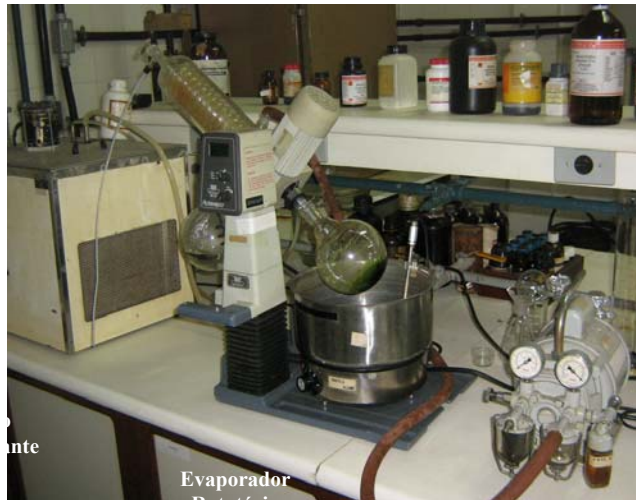
Figura 2: Foto da aparelhagem utilizada para obtenção da resina polimérica.
