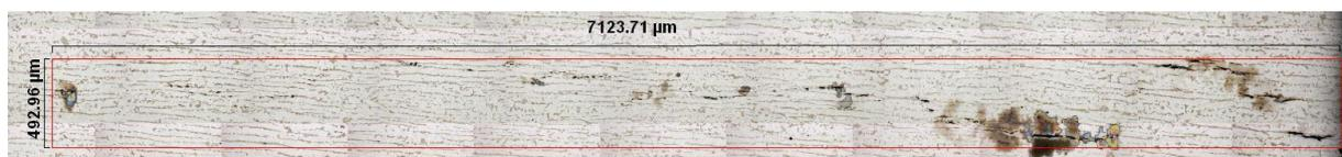
**Figura 5.** Trincas na secção central de um c-d-p API 5L B exposto a solução 177-A
