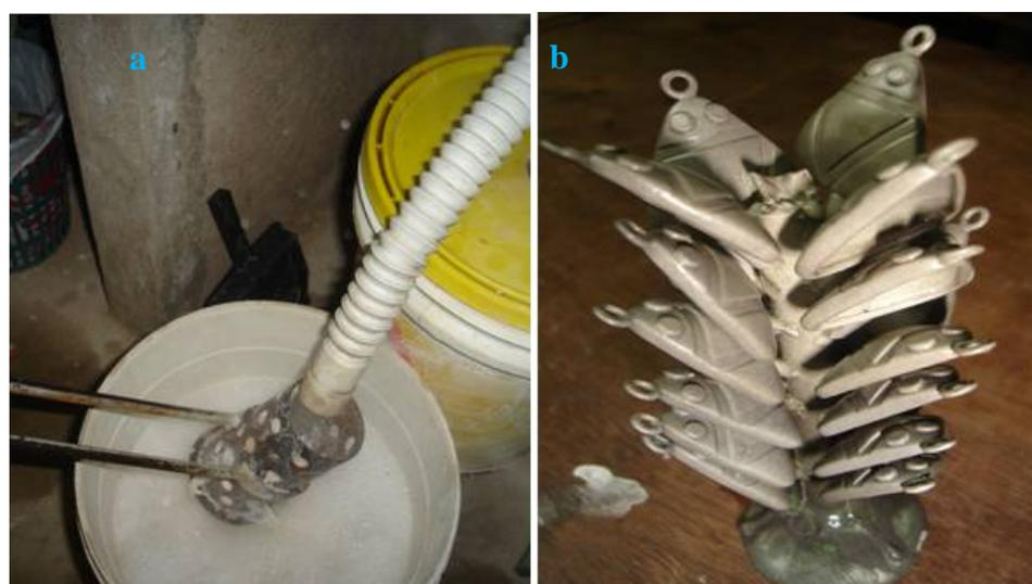
Figura 5. Remoção da massa refratária (a) e árvore das peças em prata (b).
