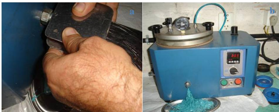
Figura 1. Obtenção dos modelos em cera (a) e injetora de cera (b).
