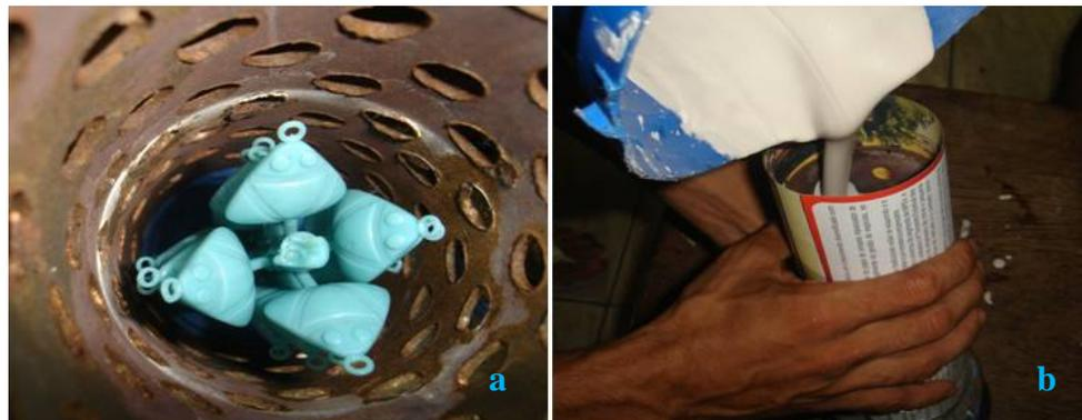
Figura 3. A árvore no cilindro (a) e material cerâmico sendo vertido sobre a árvore (b).
