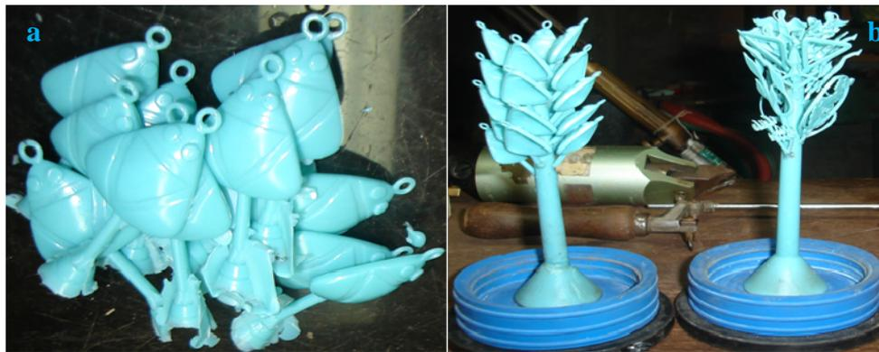
Figura 2. Modelos em cera (a) e árvores construídas (b).
