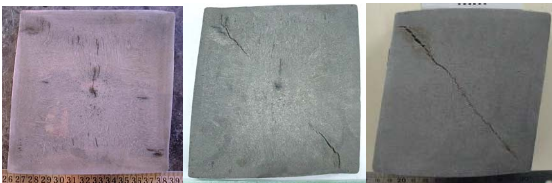
Figura 2. Diversos graus de romboidade, com diferentes graus de avanço das trincas pela diagonal que une os ângulos obtusos. Esquerda: tarugo de 120 mm x 120 mm com romboidade, mas sem trincas diagonais; (4) centro: tarugo de 130 mm x 130 mm com trinca diagonal incompleta; (4) direita: tarugo de 120 mm x 120 mm com trinca diagonal completa. (5)
