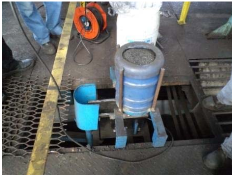
Figura 14. dispositivo de dosagem do catalisador Thermact MT na mistura de carvão.
