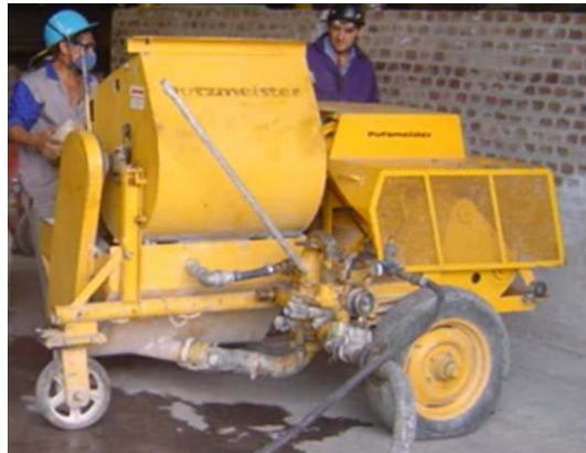
**Figura 7.** Bomba típica utilizada na aplicação de massas de injeção em Altos-Fornos.
