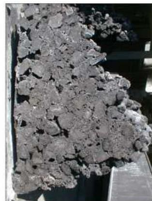
**Figura 10.** Teste de injeção da massa em uma câmara com coque incandescente.
