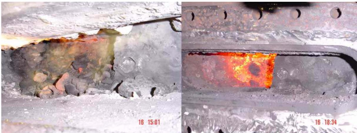
Figura 3. Detecção de desgaste dos staves de ferro fundido na primeira fiada acima das ventaneiras.
