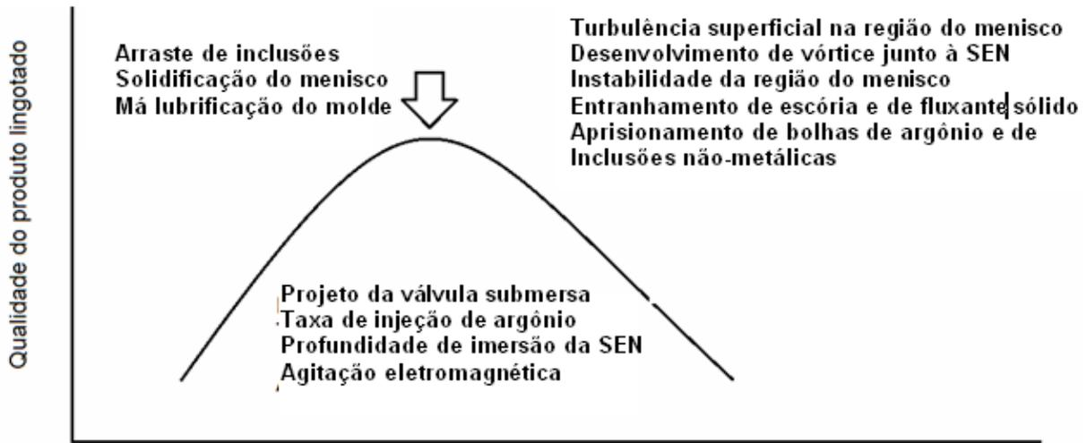
Intensidade do fluxo orientado à superfície (interface metal-fluxante)
