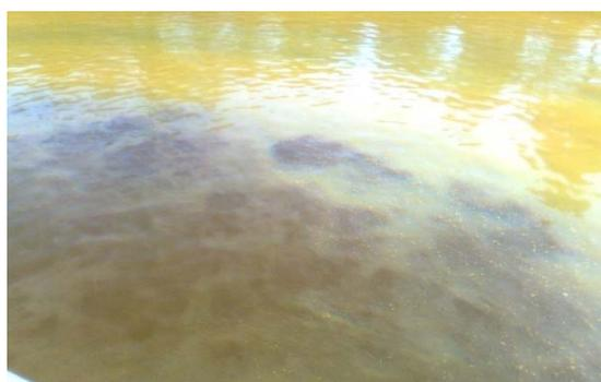
**Figura 16.** Formação de coágulos na polpa dispersa do espessador de lamas – EP 51.
