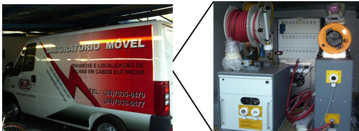
Figura 2. Fotos do Laboratório Móvel com o PHG 70/80 – Baur.
