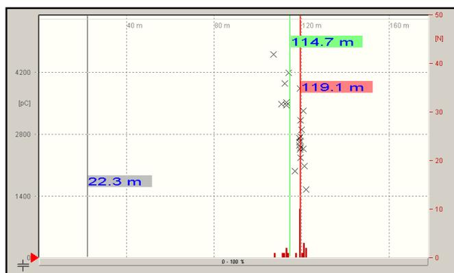
**Figura 9.** Resultado do teste de Descargas Parciais para cabo de média tensão EPR em estado crítico.
