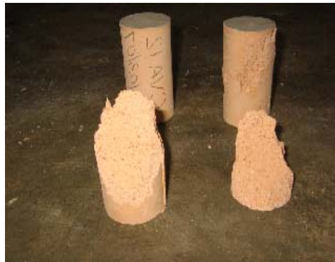
Figura 13 – Mostra do corpo de prova após rompimento.
