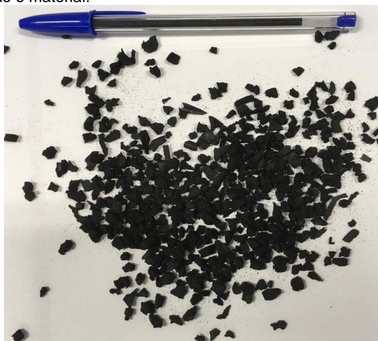
FIGURA 2 - DETALHE DA BORRACHA DE PNEU TRITURADA INJETADA NO FORNO ELÉTRICO. FONTE: AMBROSIO (2018)
