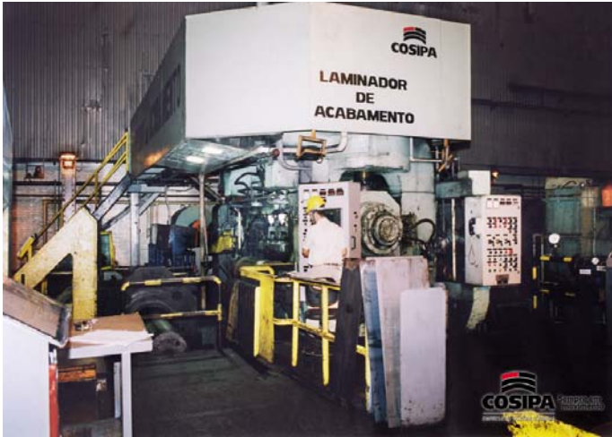
Figura 1. Laminador de Acabamento a Quente - COSIPA
