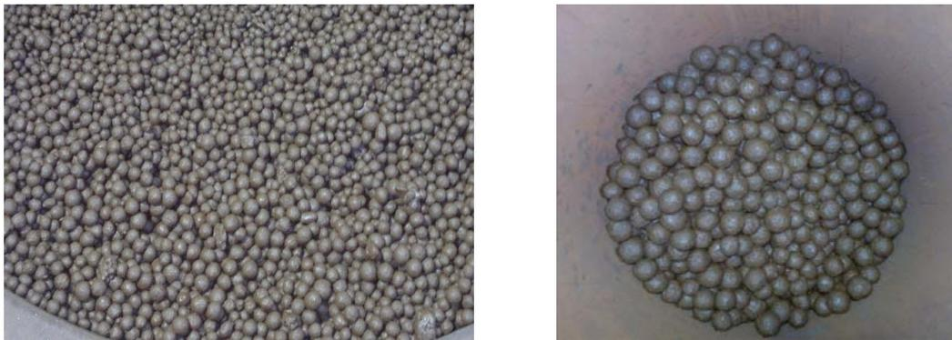
Figura 8. Pelotas cruas produzidas com adição de lama de alto-forno.
