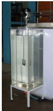
(a) Modelo em acrílico do molde se seção circular
