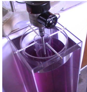
(b) Detalhe superior modelo onde é possível ver o agitador mecânico usado
