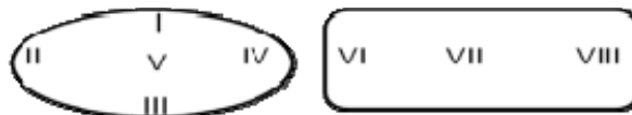
Figura 2. Esquema das medidas de dureza Vickers nas seções longitudinais e transversais das amostras.
