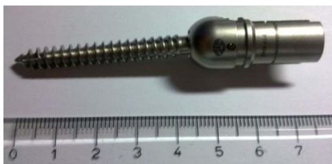
Figura 1: Parafuso poliaxial que foi cedido pela empresa OTP Biomédica.
