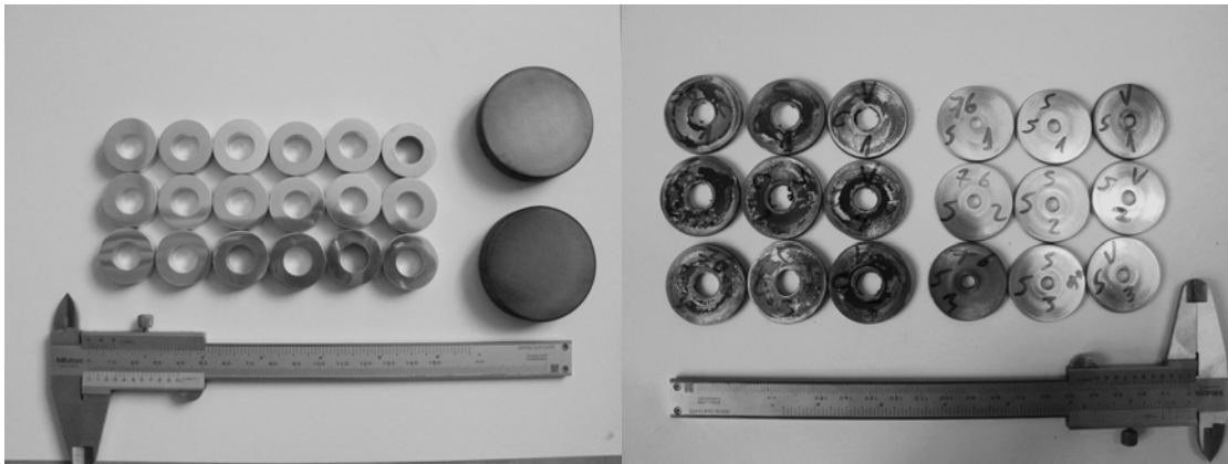
Figura 10. Anéis antes do ensaio (esquerda) e após o ensaio (direita).
