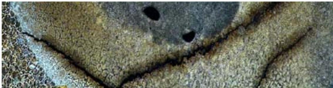
**Figura 7.** Metalografia da região de iniciação de trincas por fadiga de um dos eixos mostrado na figura 4: término de um depósito de solda (eletrodo revestido) associado com regiões tratadas termicamente e trincas [6].
