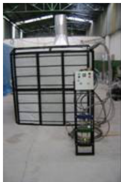
Figura 9. Endoscópio fixo acoplado em um forno modular para tratamento térmico.
