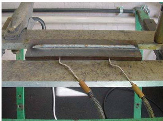
Figura 3. Placa com o cordão de solda depositado.
