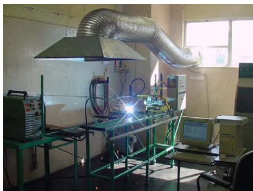
Figura 2. Sistema automatizado de soldagem em operação.
