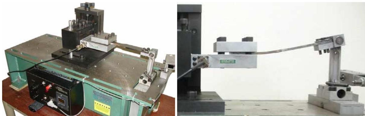
**Figura 1.** (a) Equipamento empregado nos ensaios de fadiga por flexão;(b) detalhe do corpo-de-prova fletido.
