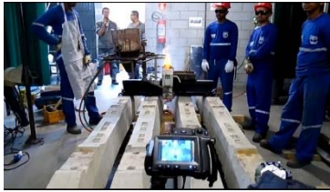
Registro termográfico no pré-aquecimento 04m:55s
